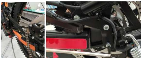
4. Attention, sur le LMX 64H, il faut dévisser au préalable la vis M6 du support de plaque avant d'enlever l'axe de la roue AR. Utilisez une clé allen de 5 mm pour cela.
