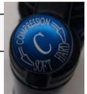
Lors du réglage, il est préférable de tourner le bouton jusqu'à la butée soft et de régler ensuite la position souhaitée. Le réglage d'usine est de 3 crans à partir de la butée "soft" (molette complètement dévissée).
