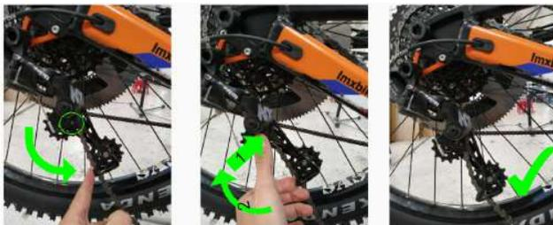
2. Passez la chaîne de pédalage sur le côté de l'axe puis détendez la chaîne du moteur.
