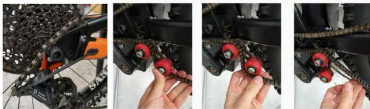
3. Passez la chaîne moteur au-dessus du bras oscillant.
