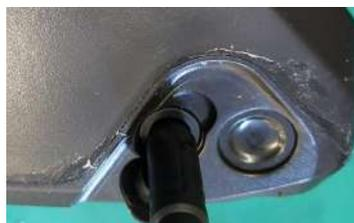
La batterie peut être chargée sur ou hors du vélo. Les chocs mécaniques tels que la chute de la batterie pendant la manipulation doivent être évités. Pour installer la batterie sur le cadre, faites-la glisser vers l'arrière dans le canal en U du cadre et assurez-vous de le faire lorsque la batterie est complètement au fond. Un clic indique que la batterie est verrouillée en place.
