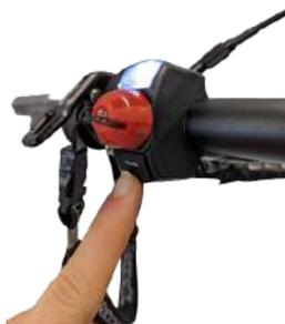
Lorsque le LMX 56 s'allume, il est automatiquement en mode N (Neutre).
