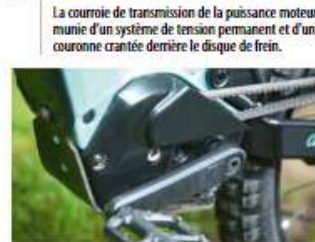
Le moteur LMX, lui aussi assemblé à Jonage, promet 175 Nm de couple à la roue arrière. On aperçoit le sabot de protection.
