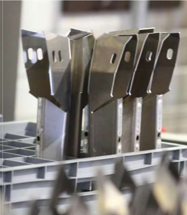
Au départ, des tubes en alu aux normes aéronautiques en provenance d'Asie, mais usinés, assemblés et soudés en interne. Dans le bureau d'études, de nouvelles pièces prennent forme en CAO 3d. Dans l'atelier d'assemblage, un outillage spécifique obligatoire pour un véhicule homologué. Les moteurs sont assemblés et câblés en interne.
