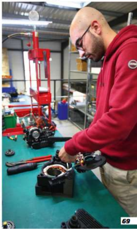
Au départ, des tubes en alu aux normes aéronautiques en provenance d'Asie, mais usinés, assemblés et soudés en interne. Dans le bureau d'études, de nouvelles pièces prennent forme en CAO 3d. Dans l'atelier d'assemblage, un outillage spécifique obligatoire pour un véhicule homologué. Les moteurs sont assemblés et câblés en interne.
