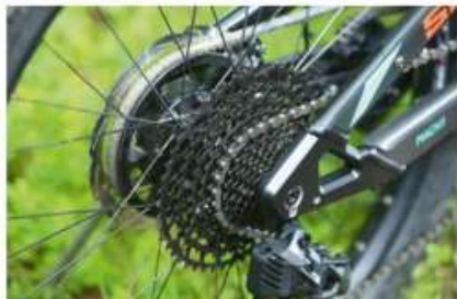
À droite la poignée de gaz et à gauche le sélecteur de mode, la commande de tige de selle télescopique AXS ainsi qu'un coupe-contact que l'on peut attacher au poignet. Chaîne et dérailleur AXS ne font qu'encaisser le pédalage (l'assistance moteur passe par la courroie). L'usure sera minimale dans le temps...
