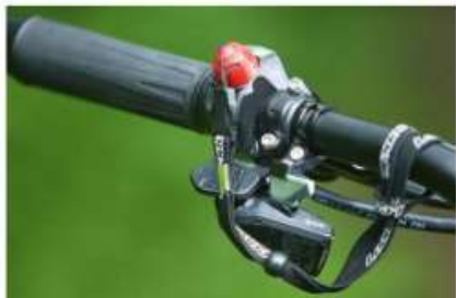
À droite la poignée de gaz et à gauche le sélecteur de mode, la commande de tige de selle télescopique AXS ainsi qu'un coupe-contact que l'on peut attacher au poignet. Chaîne et dérailleur AXS ne font qu'encaisser le pédalage (l'assistance moteur passe par la courroie). L'usure sera minimale dans le temps...
